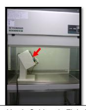
Fotografía No. 8: Cabina de Flujo Laminar. La flecha señala el sellador de las bolsas de Crio preservación.
