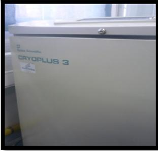
Fotografía No. 5: Tanque de Nitrógeno, Refrigeración de  $-150^{\circ}\text{C}$
