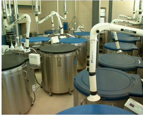
Figura N°7 Almacenamiento en tanque de nitrógeno
