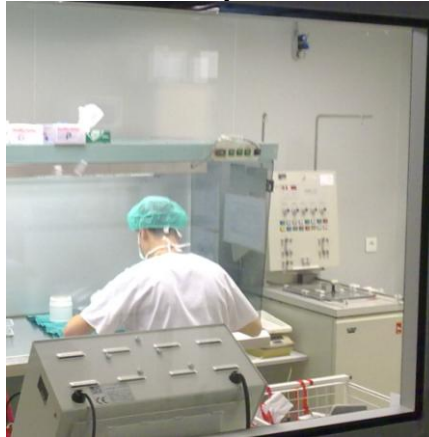
Figura N°2 Cabina de flujo laminar
